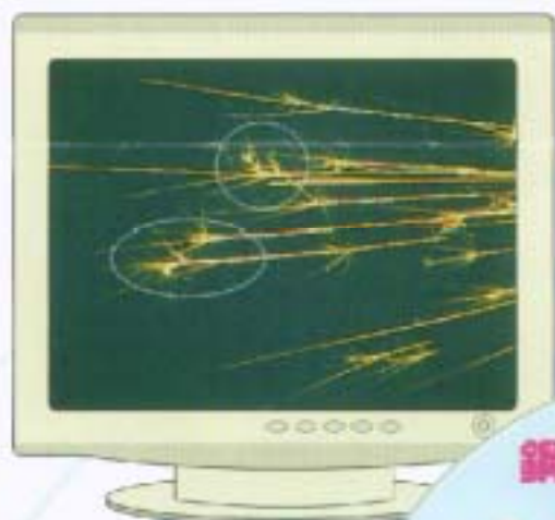
●飛びだした火花を映像化 (S50Cの例)
