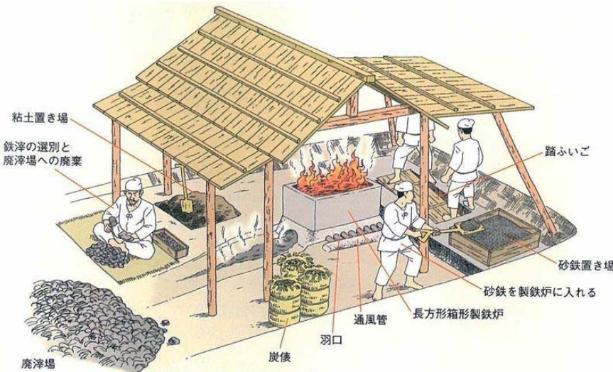
図39 ●9世紀前半の製鉄のようす 鳥打沢A遺跡の製鉄炉を参考に復元した操業のイメージ。
