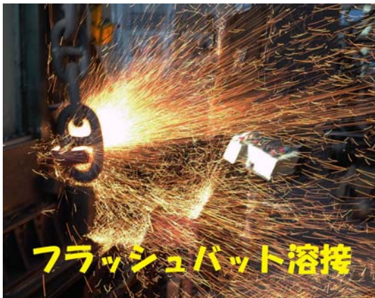
①昭和30年代鍛接鎖の様子 ②フラッシュバット溶接
